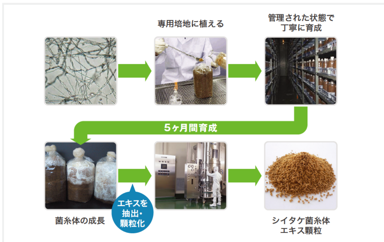
図2:シイタケ菌糸体抽出物の生産・製造工程
